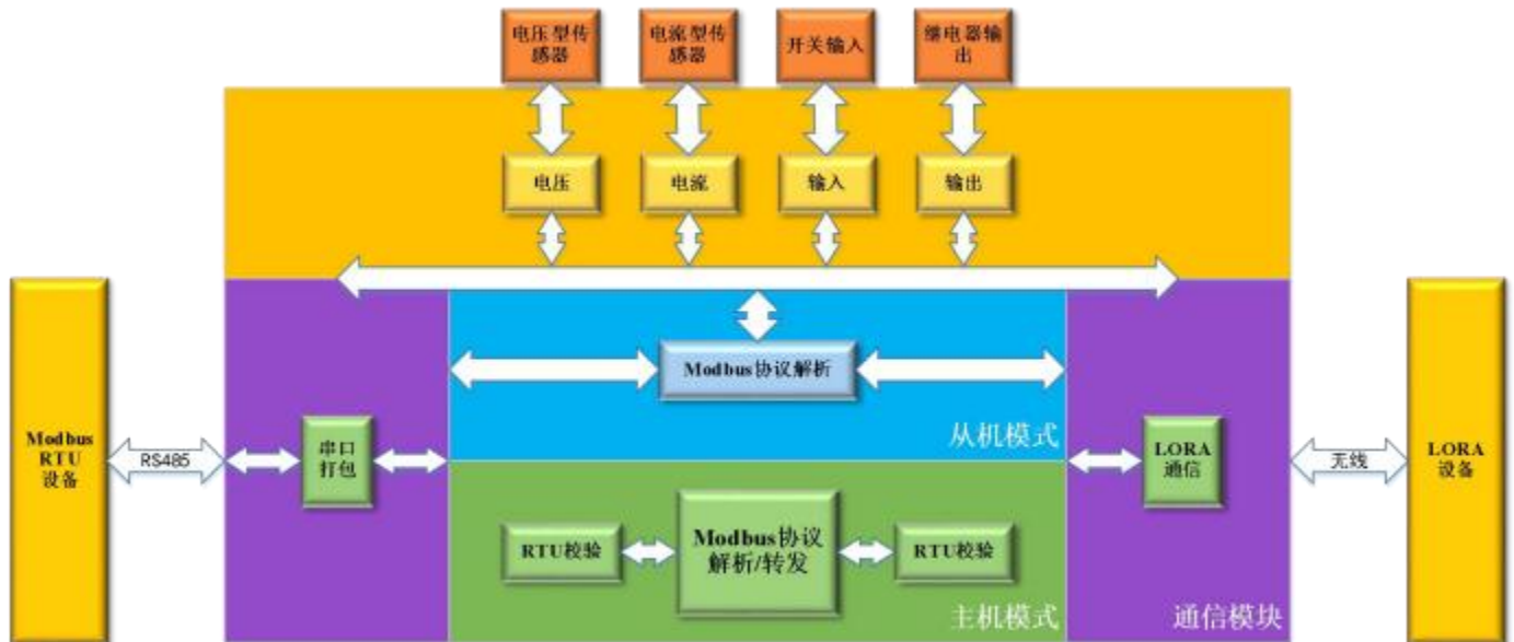
图 12 USR-IO34-LR 功能框图
